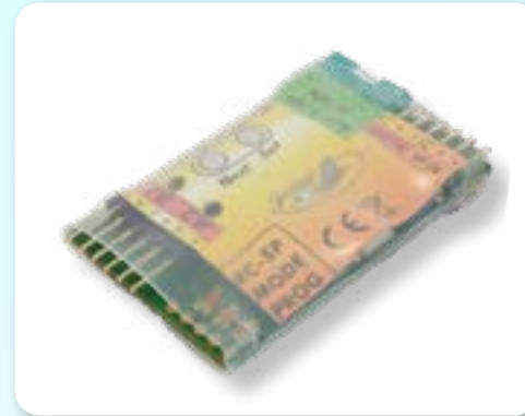
Direkter Anschluss der LCU an die ECU über das LED-I/O Interface. (Stromversorgung und Daten)
