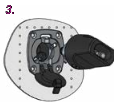
Die Nippel der Befüllkupplung zu den Bohrungen im Ventil ausrichten
