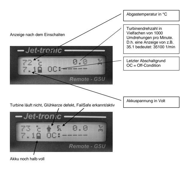
Turbine läuft, Turbine wird von der GSU aus gesteuert (Pfeil Symbol)
