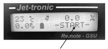
Während des Startvorganges wird unten rechts der Turbinenzustand anstatt des Abschaltgrundes angezeigt.
