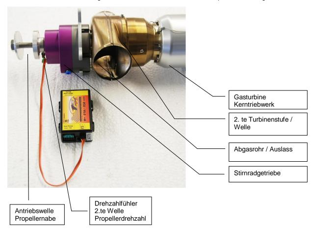
Die ECU überwacht und regelt das Triebwerk auch durch Messung der Propellerdrehzahl. Bei defektem oder nicht eingesteckten Drehzahlfühler für die 2.Welle, lässt sich das Triebwerk zwar normal starten und betreiben, aber die maximale Drehzahl der Primärturbine wird auf 115.000 1/min begrenzt (statt möglichen 165.000 1/min)!
