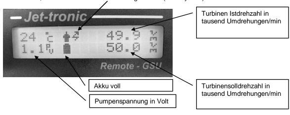
Bei Zweiwellentriebwerken (z.B. SPT5/SPH5) wird im Betrieb die Propellerdrehzahl unten links, anstelle der Pumpenspannung sowie Batterieinformation, angezeigt!
