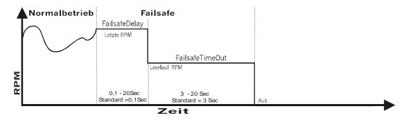
Sie können im **RC CHECK Menu** die Failsafe Funktion überprüfen. Drücken und halten Sie hierzu die **Select Menu** Taste der GSU und drücken dann die + Taste bis das **RC-Check Menu** angezeigt wird. Lassen Sie die "**Select Menu**" Taste jetzt wieder los, die Anzeige sollte nun folgendes anzeigen: (Die angezeigten Werte hängen von der Position des Gasknüppels ab)
