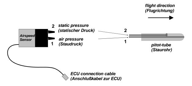
Die Verbindung der Luftdruckanschlüsse 1 (=Staudruck) und 2 (=Umgebungsdruck) erfolgt mittels der beiliegenden Schläuche. Die Schlauchlänge sowie der Schlauchquerschnitt haben <u>keinen</u> Einfluss auf Genauigkeit der Messung.
