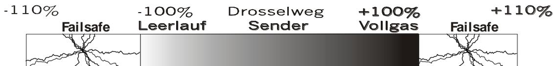
Damit bei PCM die ECU feststellen kann ob ein Failsafe vorliegt, ist der Sender so zu programmieren, dass im Failsafefall empfängerseitig Impulse ankommen welche eindeutig außerhalb des zuvor eingelernten Bereichs liegen.
