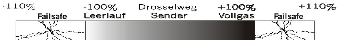
Damit bei PCM die ECU feststellen kann ob ein Failsafe vorliegt, ist der Sender so zu programmieren, dass im Failsafefall empfängerseitig Impulse ankommen welche eindeutig ausserhalb des zuvor eingelernten Bereichs liegen.
