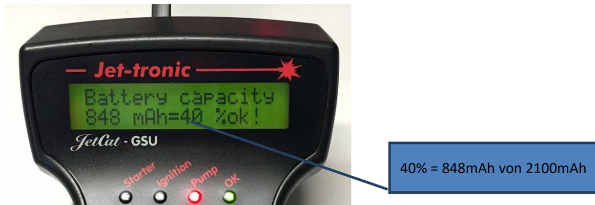
Der angezeigte Wert wird auf den maximalen Wert gesetzt sobald der Parameter **“Battery size”** im Limits Menü verstellt wird. → Nach Einstellen dieses Parameters geht das System dann davon aus, dass ein frisch geladener Akku an die ECU angeschlossen wurde.
