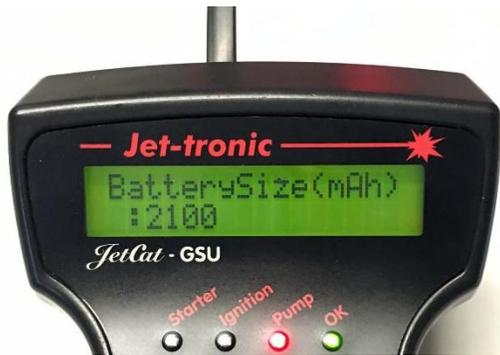
Die eingestellte Akkukapazität wird verwendet um den „Füllstand“ des Turbinenakkus zu berechnen. Dieser Wert beeinflusst nur den berechneten/angezeigten Akku-Füllstandswert und hat keinen Einfluss auf die Funktion des Ladesystems.
